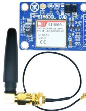
Fig5. SIM800L GSM Module
